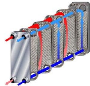
Durch grosse Übertragungsflächen bei kompakten Aussenabmessungen werden hohe Heiz- bzw. Kühlleistungen erreicht.
